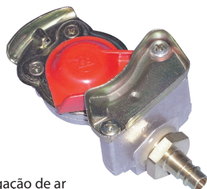
Ligação de ar comprimido de camião
