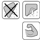
Aplique o remendo na zona danificada e esfregue toda a superfície com um objeto rombo a alta pressão. Siga as instruções para a cura do adesivo.
