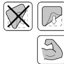
Kistom tanko nanesite lijepilo\* po čitavoj površini oštećenog mesta i glatke PVC strane zakrpe. Pričekajte 5 do 10 minuta.
