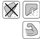
Använd en pensel för att applicera lim\* i ett tunt lager över hela ytan på det skadade stället samt på den släta sidan av PVC-lappen. Vänta i 5–10 minuter.
