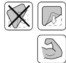
Aplicați peticul pe zona deteriorată și frecăti întreaga suprafață cu un obiect bont, cu o presiune mare. Respectați instrucțiunile privind întărirea adezivului.
