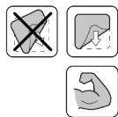
Με ένα πινέλο, εφαρμόστε μια λεπτή και επίπεδη στρώση κόλλας\* στο χαλασμένο σημείο καθώς και στη λεία πλευρά PVC του μπαλώματος. Περιμένετε 5 - 10 λεπτά.
