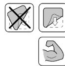
Nanieść pędzelkiem cienką, dobrze kryjącą warstwę kleju\* na uszkodzone miejsce oraz na gładką powierzchnię łat z PVC. Zaczekać 5–10 minut.
