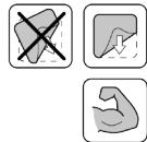
Ar otīju uzklājiet limi\* plānā kārtīņā uz bojātās vietas, nosedzot visu ielāpa laukumu, un uz ielāpa gludās PVC puses. Pagaidiet 5-10 minūtes.
