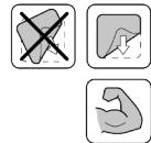
Læg lappen passende på det beskadigte sted, og brug en stump genstand til at gnide mod hele overfladen med højt tryk. Overhold anvisningerne vedr. limens hærdning.
